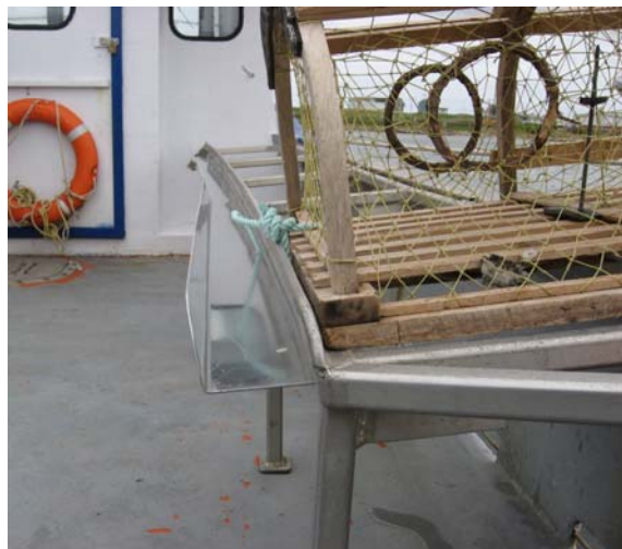
Gouttière pour le cordage
