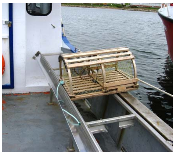
Gouttière pour le cordage
